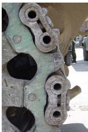
Rys. 9. Koła gąsienicy stalowej (a) i gumowej (b) Fig. 9. Link Track Sprocket (a) and Band Track Sprocket (b)
