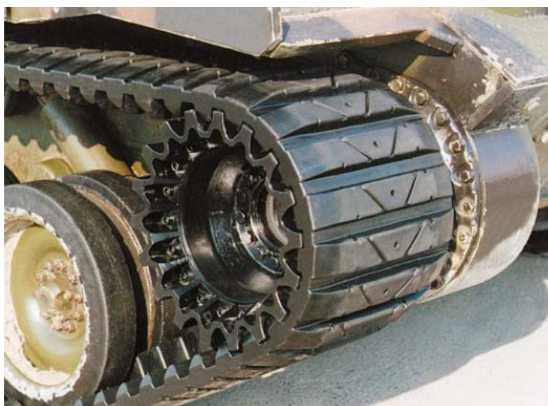
Rys. 20. Francuski hybrydowy pojazd gąsienicowy: a – koncepcja ogólna, b – koło zębate gumowej gąsienicy Fig 20. French hybrid tracked demonstrator: a – general concept, b – rubber track sprocket
